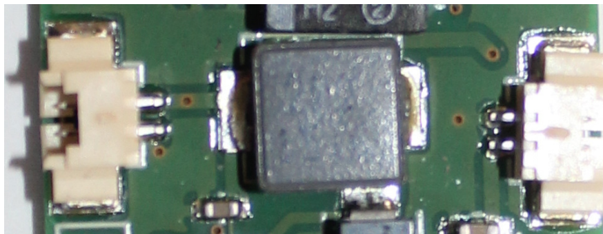
Fig. 3. Pistes larges pour le circuit d'alimentation
